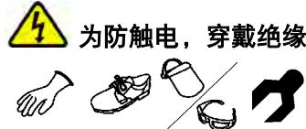
为防触电，穿戴绝缘保护装置并使用绝缘工具。
