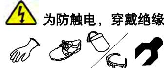
为防触电，穿戴绝缘保护装置并使用绝缘工具。
